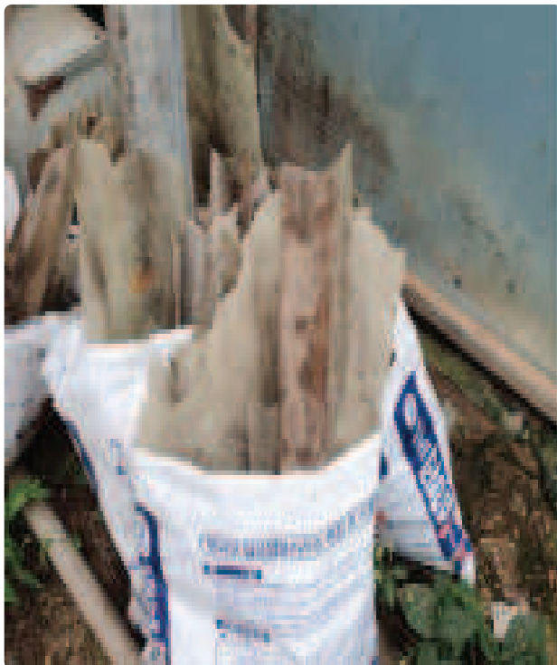
[사진2] 재해자와 함께 파단된 선라이트 및 교체중이던 선라이트 모습
