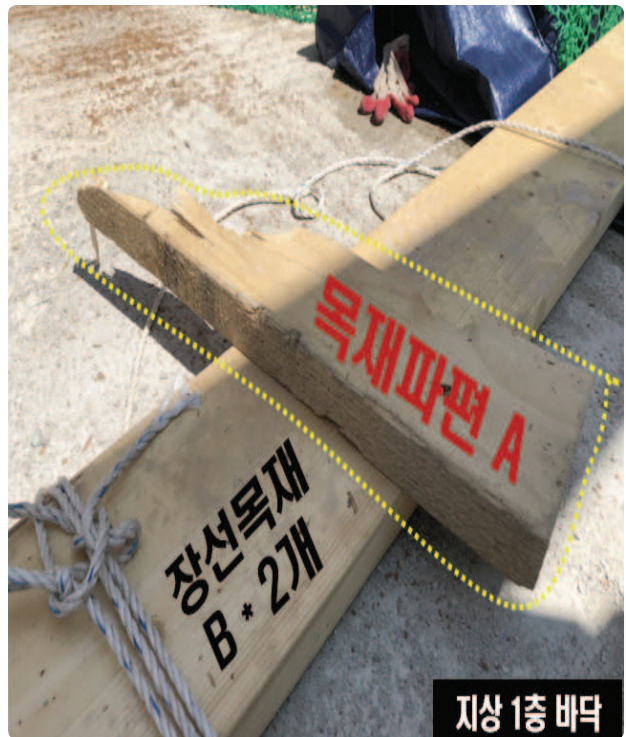
[사진2] 재해자와 함께 파단된 것으로 추정되는 목재 모습
