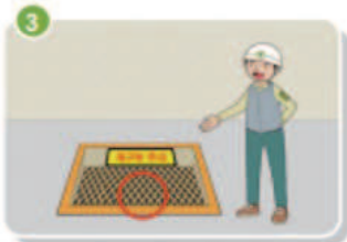
3 개구부에 덮개 설치 시 뒤집히거나 떨어지지 않도록 설치
