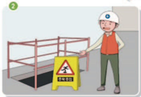
2 작업발판 및 통로 끝, 개구부 등 추락위험장소에 안전간판 등 설치
