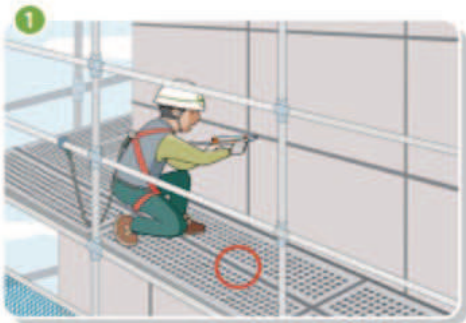
1 추락 또는 넘어짐 위험장소에 작업발판 설치
